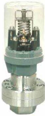
単極双投接点を備え、設定圧力の上限、下限において同時にON-OFFの2点制御信号が得られ必要に応じ設定圧力値の変更ができる圧力自動制御スイッチです。
