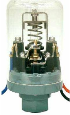
単極双投接点を備え、設定圧力の上限、下限において同時にON-OFFの2点制御信号が得られ必要に応じ設定圧力値の変更ができる圧力自動制御スイッチです。
