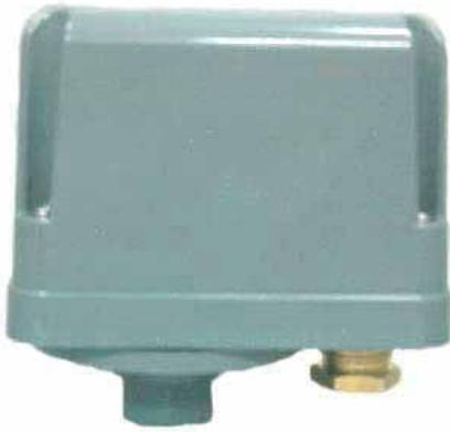
単極双投接点を備え、設定圧力の上限、下限において同時にON-OFFの2点制御信号が得られ必要に応じ設定真空度の変更ができる真空自動制御スイッチです。
